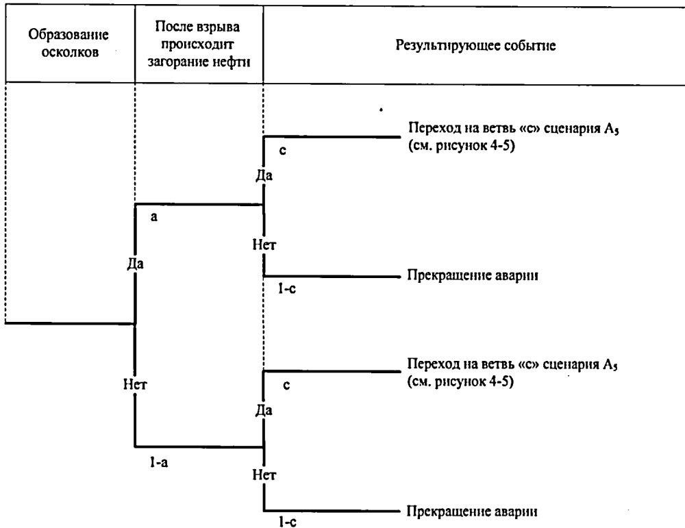
Рис. 6 – «Дерево событий» при взрыве внутри подземного резервуара (типа ЖБР) (сценарий А 6 )
